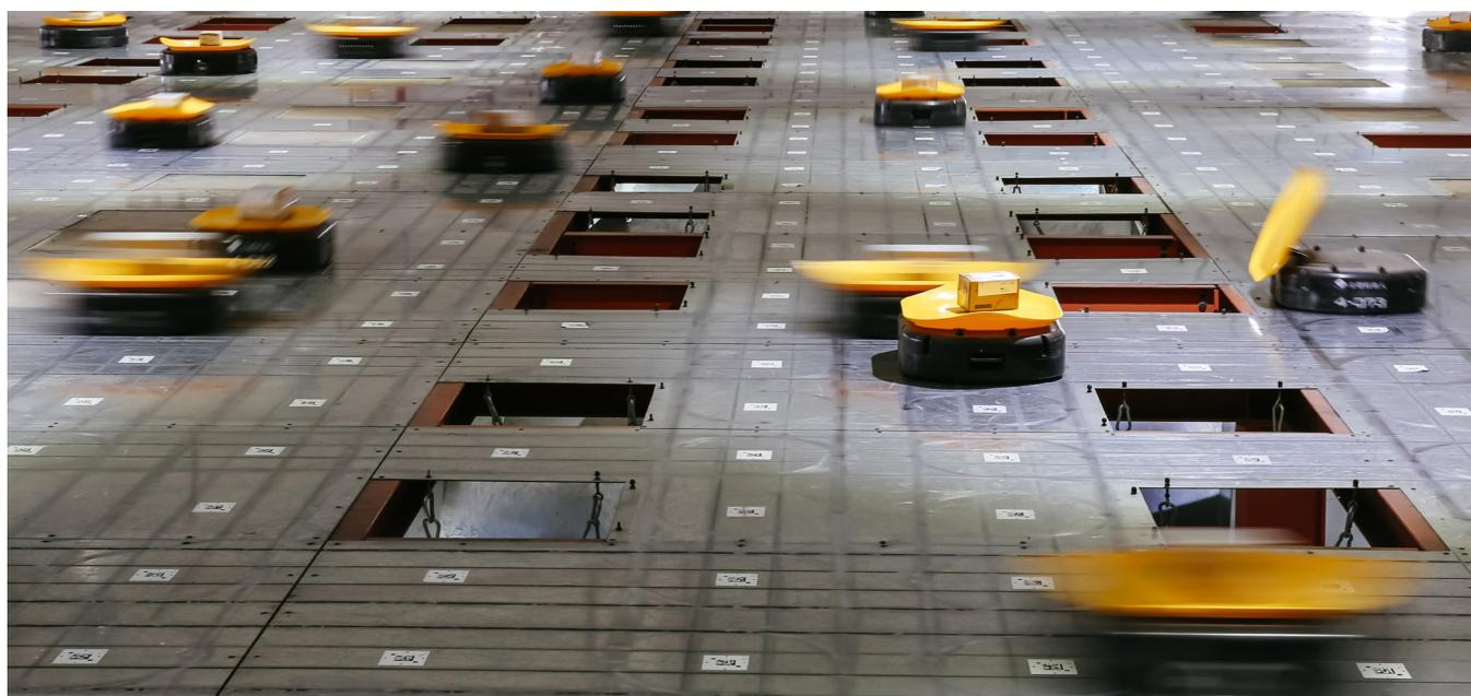
全国首个跨境电商智能机器人仓库采用机器人进行自动仓储管理、自动拣货、自动分拣、自动查验等工作
