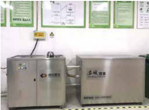
厨余垃圾生物分解设备（采集阶段）
